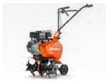
HUSQVARNA TF 120 Einfache, praktische Motorhacke für den Hausgarten, die leicht zu manövrieren ist. Vertikutierer als Zubehör erhältlich. Zusammenklappbarer Holm und Transportrad. Rato R100 Motor, Kette/manuelles Getriebe, Arbeitsbreite 46 cm, Arbeitstiefe ≈ 15 cm. 967 10 08-01 CHF 620.-
