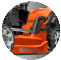
Zentrale Schnitthöhenverstellung ermöglicht eine schnelle und einfache Einstellung der Schnitthöhe
